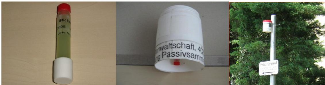
Abbildungen: Prüfröhrchen, Schutzvorrichtung mit eingehängtem Prüfröhrchen, exponierte Messvorrichtung
