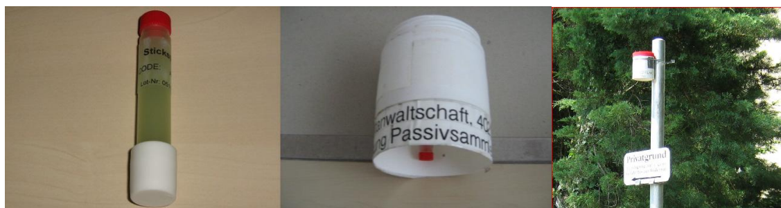
Abbildungen: Prüfröhrchen, Schutzvorrichtung mit eingehängtem Prüfröhrchen, exponierte Messvorrichtung
