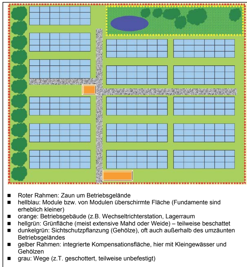
Abbildung 4: Schema einer Photovoltaik-Freiflächenanlage 16
