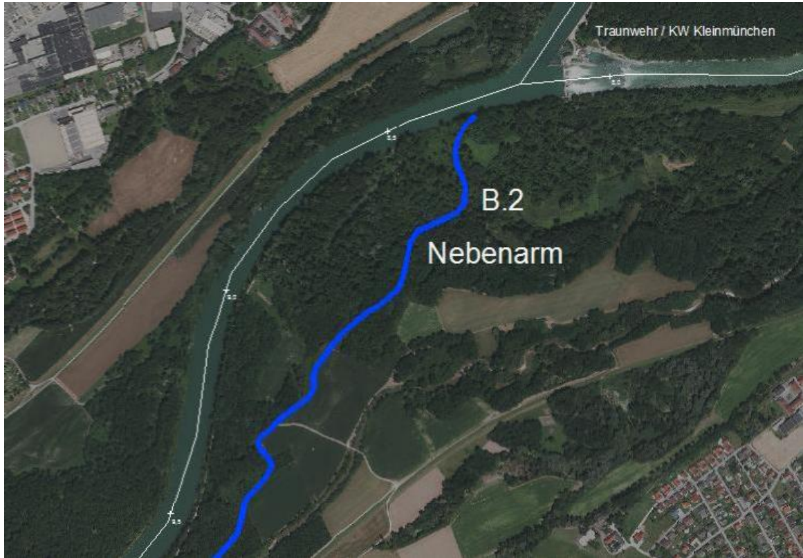
Abbildung 73: Variante 2 der unterstromigen Anbindung des Nebenarms des Stauraums Traunwehr/Kleinmünchen
