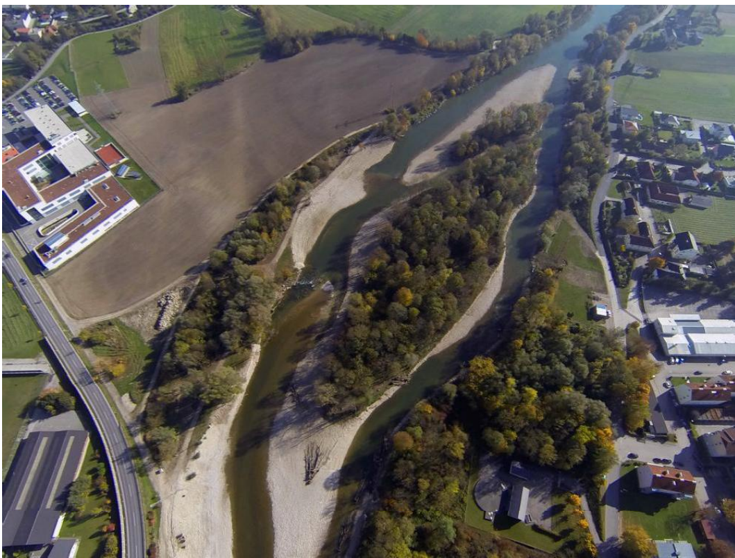
Abbildung 45: Neu geschaffener Nebenarm (rechts) mit Kiesumlagerung in den Hauptarm (links) der Ybbs (LIFE+ Projekt Mostviertel).
