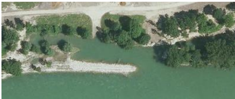
Abbildung 91: Oben: Sicherung der Einströmöffnung des Nebenarmes durch Blockwurfsteine; Unten: Anbindungsbereich Altarm (links) / Nebenarm (rechts);
