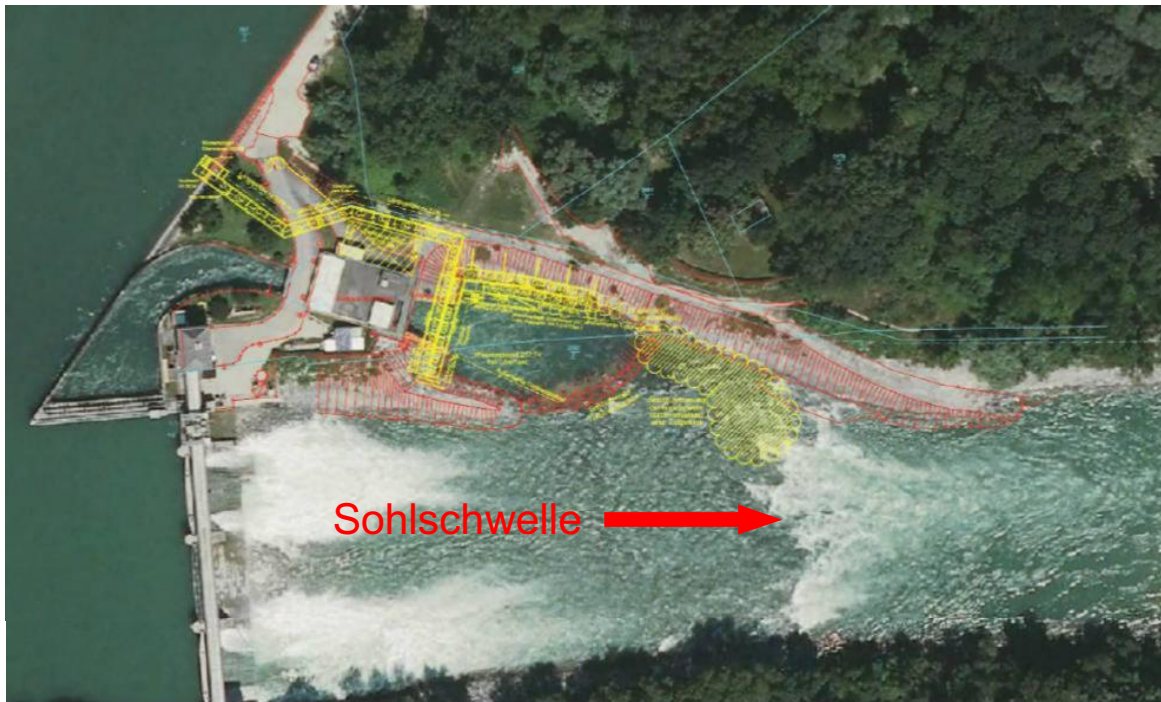
Abbildung 66: Planausschnitt der Einreichplanung zur Herstellung der Fischpassierbarkeit an der Wehranlage der Wasserkraftanlage Kleinmünchen (Quelle Einreichplan FAH der Wehranlage des KW Kleinmünchen, Büro Blattfisch)
