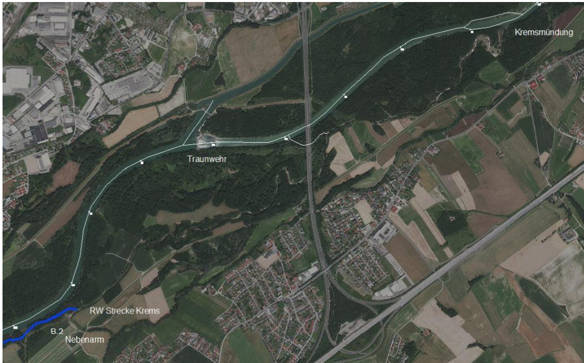
Abbildung 74: Variante 3 - Mündung des Nebenarms B.2 in die RW Strecke der Kreams bei fkm 4,42 unterhalb der Ausleitung der Kreams (Lell-Wehr)
