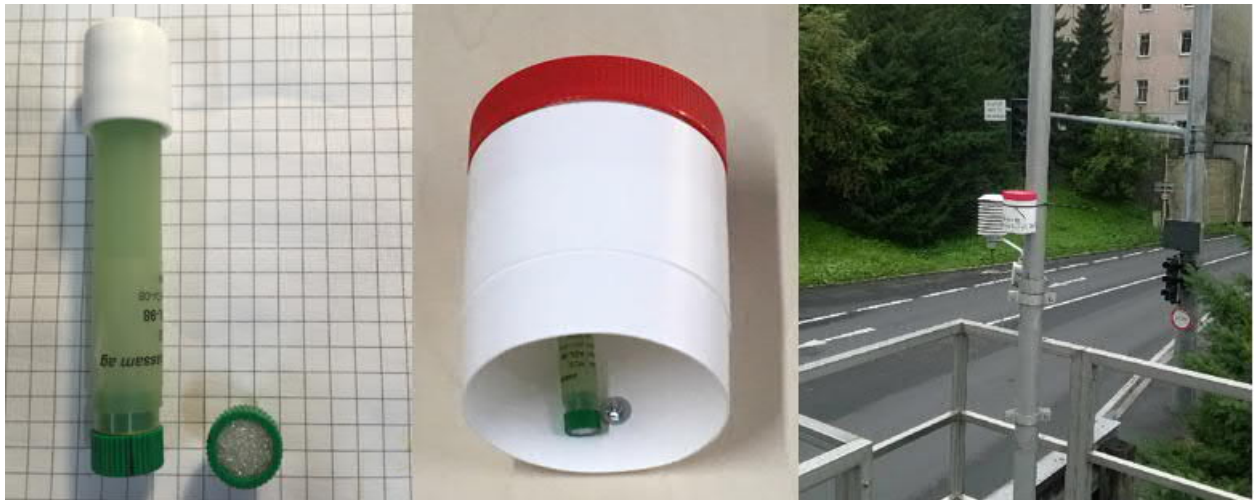
Abbildungen: Prüfröhrchen mit Glasmembran-Fritte, Schutzvorrichtung mit eingehängtem Prüfröhrchen, exponierte Messvorrichtung
