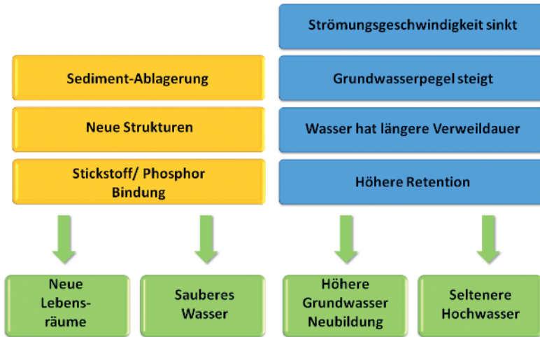
Abb. 3.9. Schema der Gewässerreinigung durch Biberdämme (© G. Hölzler, nach ZAHNER ET AL 2009, verändert).
