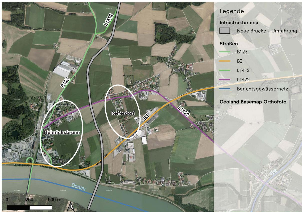
**ABBILDUNG 1: VERORTUNG DER NEUEN DONAUBRÜCKE UND GEPLANTEN UMFÄHRUNGSSTRAÙE HEINRICHSBRUNN IN KOMBINATION MIT VORHANDENEN HOCHRANGIGEN BUNDES- UND LANDESSTRAÙEN. DIE SIEDLUNGEN HEINRICHSBRUNN UND REIFERDORF SIND ALS WEIÙE KREISE EINGEZEICHNET (DATEN: LAND OÖ, BEARBEITUNG: MCINNES, 2021).**
